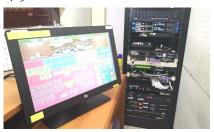
ネルにより、テロップの表示やマイク・カメラのコントロール、映像の切り替え、録画・録音の開始・停止など、様々な操作を行います。
