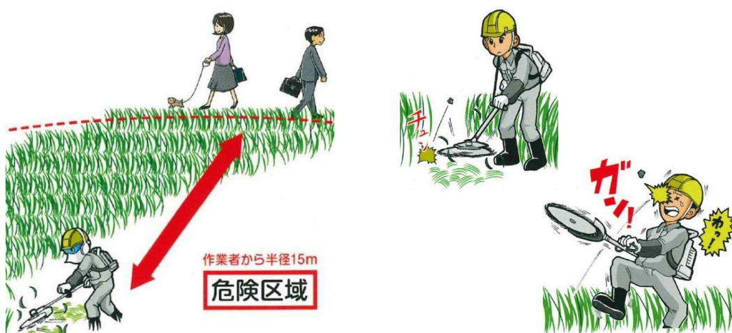
図 1.21 飛石の発生と作業者への衝突
