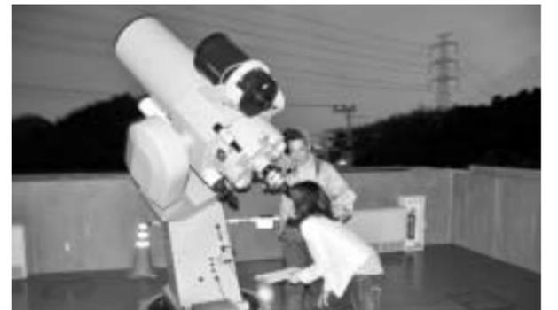
大型望遠鏡で星見。見たい星をパソコンで入力すると、自動で動きピンポイントにその星を見ることができます。
