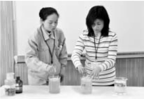
加古川の水に凝集剤を入れたミニ実験。濁りの成分が固まって沈殿。浄水処理のようすがよく分かります。
