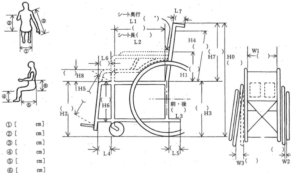
(注)H1はパッド有はパッドの上端、無はフレームの上端とする。(単位:mm)
