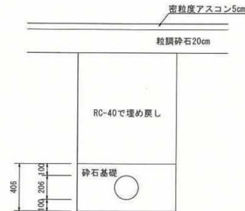
下水道新設管掘削標準土工図 S=1/30
