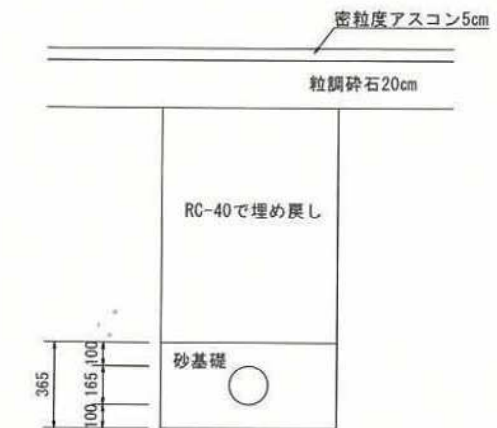
下水道取付管掘削標準土工図 S=1/30
