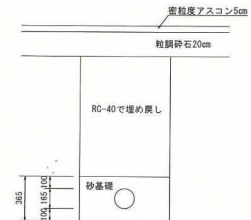
下水道取付管掘削標準土工図 S=1/30
