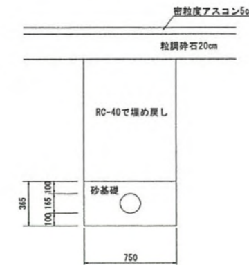
下水道取付管掘削標準土工図 S=1/30 VU φ150
