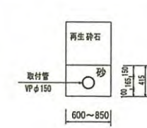
取付管砂保護工 S=1/50
