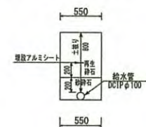
給水管敷設断面図 S=1/50
