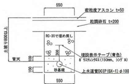
水道管掘削標準土工図 S=1/30
