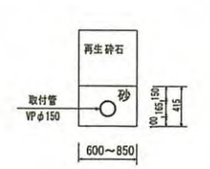
取付管砂保護工 S=1/50
