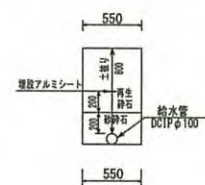
給水管敷設断面図 S=1/50
