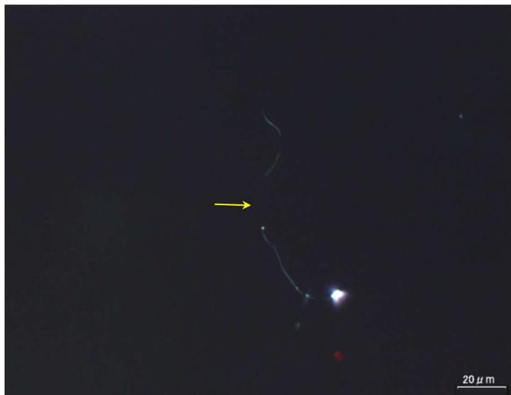
クリソタイル標準試料をメンブレンフィルターに捕集。
