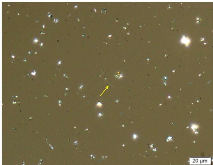
クリンタイル標準試料をメンブレンフィルターに捕集。
