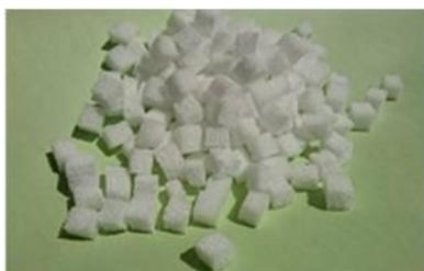
加水分解により劣化・摩耗するため担体を4 m<sup>3</sup>補充しました。充填率の維持により処理効率の悪化防止に繋がりました。平成29年度より劣化の激しい浮上槽をステンレス鋼板ライニングによる補修を開始し、令和2年度はV期目の工事を行いました。
