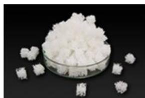
加水分解により劣化や摩耗するため、担体を2.4m<sup>3</sup>補充しました。充填率の維持により処理効率の悪化防止に繋がりました。
