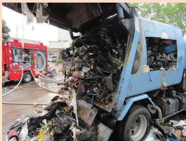
▲ごみ収集車両の中で火災が発生するとハッチが開かなくなり、ボディを切り開かなければ消火できなくなることがあります。
