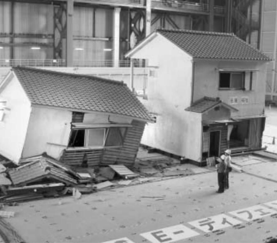
昭和56年以前に建築された住宅の振動実験。2棟の同じ住宅を、そのまま（左側）と耐震補強した場合（右側）で阪神・淡路大震災と同じ揺れで振動させた。（提供：防災科学技術研究所）
