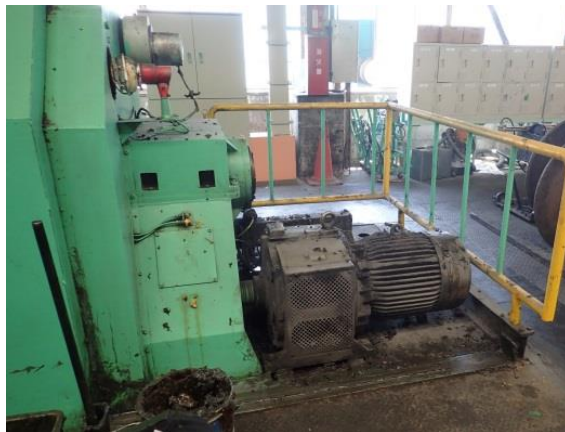
図1 撚線機 モーターインバータ化
