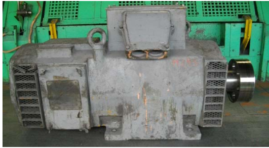
図2 撚線機 モーターインバータ化
